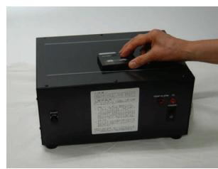
DDS Data Cartridge, Digital Video Cassetteの場合は、磁気媒体の両面を消去することで消去効果が上がります。
