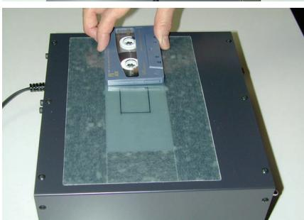
反対方向の端まで移動したら、磁気テープを90度回転させ、ゆっくりと逆の端まで移動させます。
