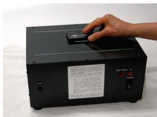
装置の中心にある□マークの周辺を、一周5秒程度の速度で12回転させた後、Cartridge又はVideo Cassetteのもうひとつの片面を、同様に□マークの周辺を、一周5秒程度の速度で12回転させることで、ブランクメディアとして確認されるまでに消去されます。
